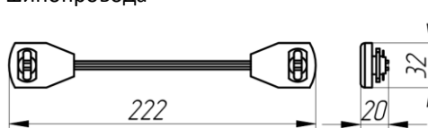
Соединитель гибкий кабельный Geniled для однофазного шинопровода
